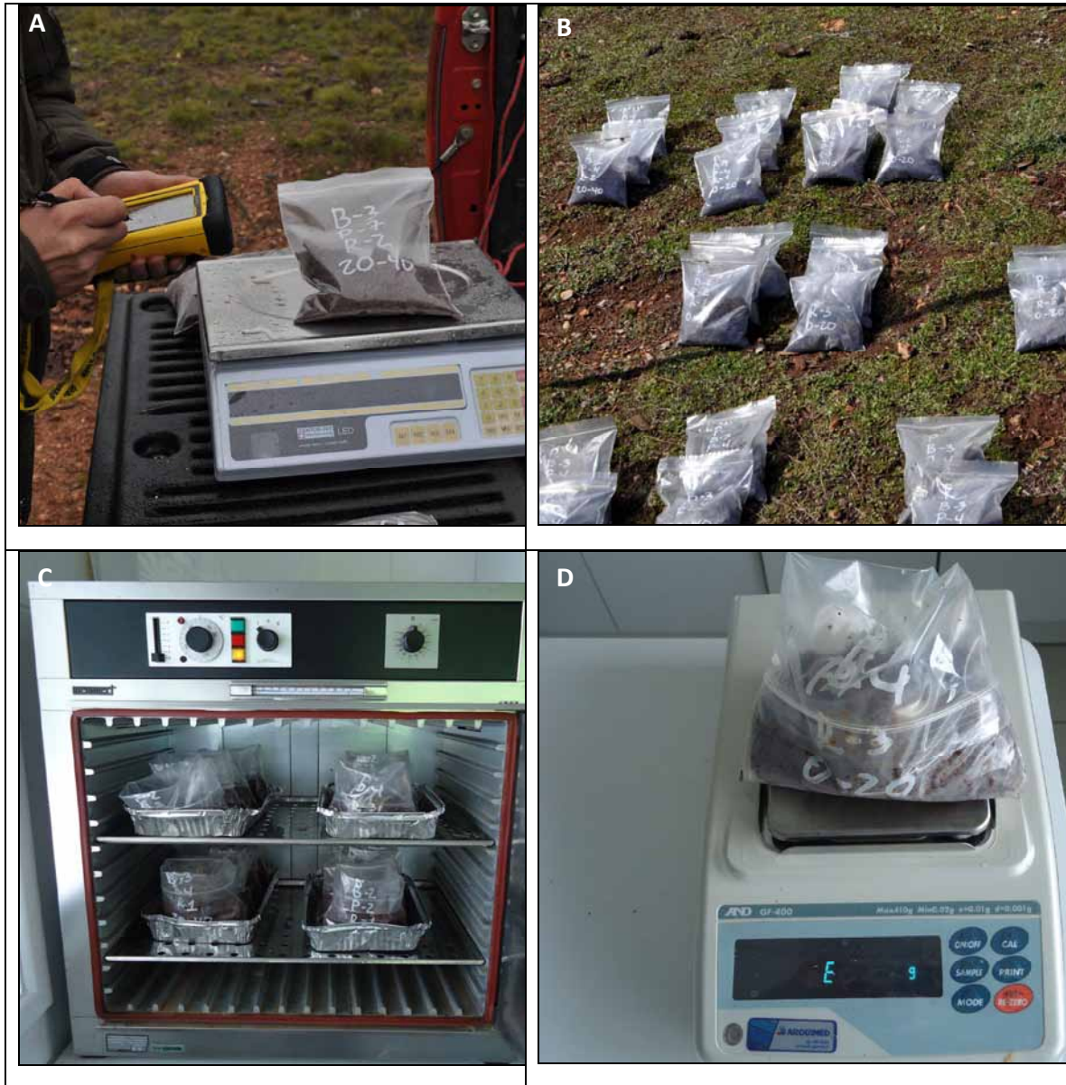
Figura 6. Medición de contenido de humedad en el suelo. A) Registro de peso de la muestra con el captador de datos B) Identificación del total muestras recolectadas. C) Secado de muestras en horno a 105°C en laboratorio. D) Peso de muestra seca.
