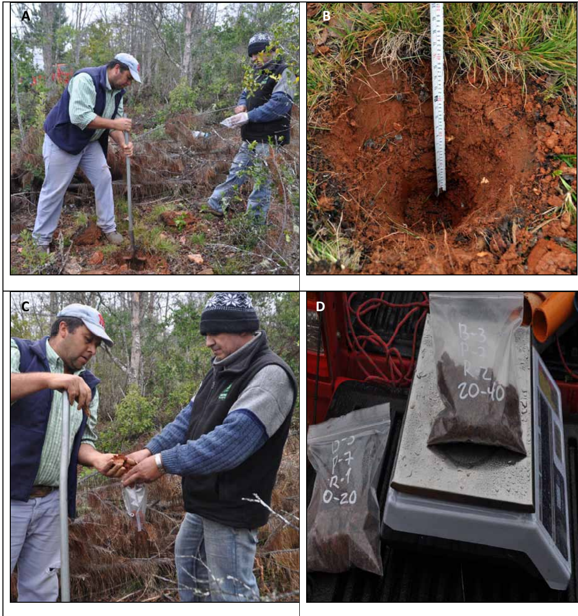
Figura 5. Medición de contenido de humedad en el suelo. A) Recolección de muestra de suelo desde 0 – 20 cm de profundidad. B) Punto de muestreo. C) Almacenamiento de muestras en bolsa hermética. D) Registro del peso de la muestra en terreno.
